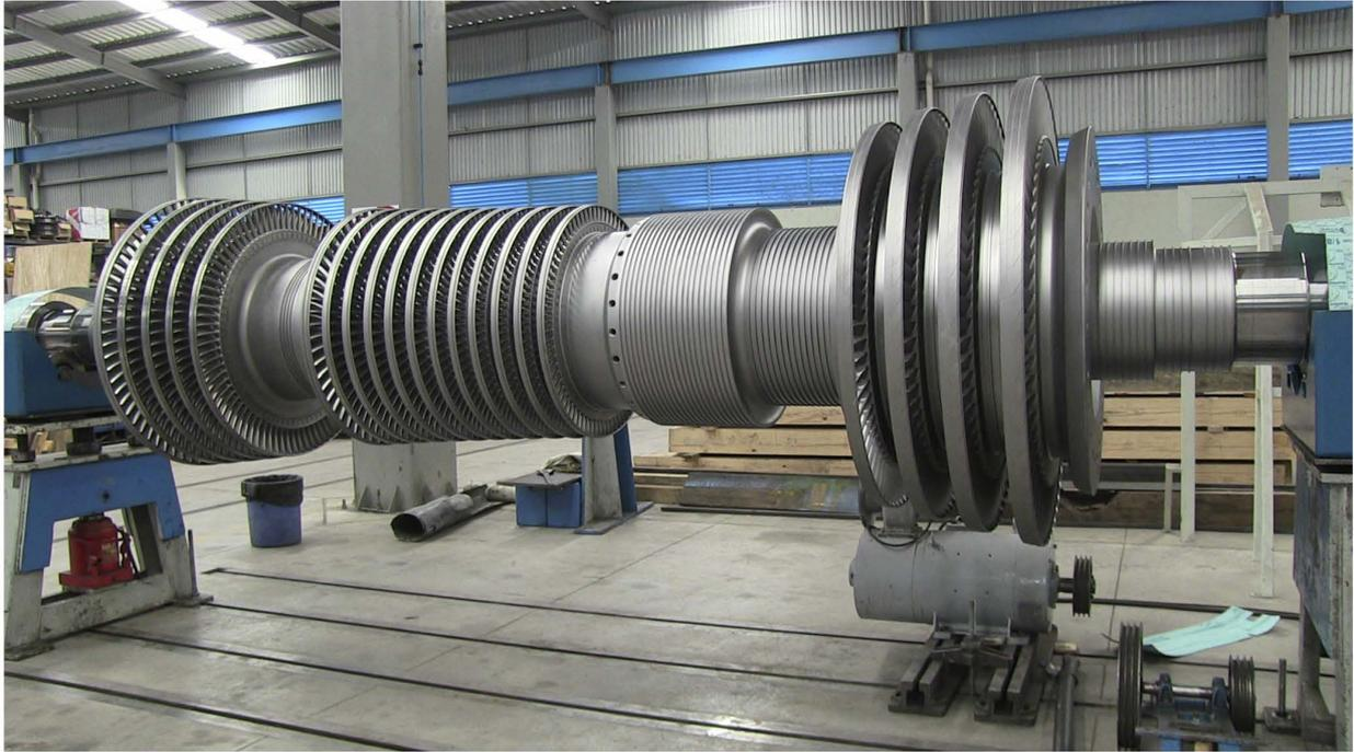
Capacidad para realizar el balanceo dinámico de rotores de turbinas de vapor de hasta 678mw.
